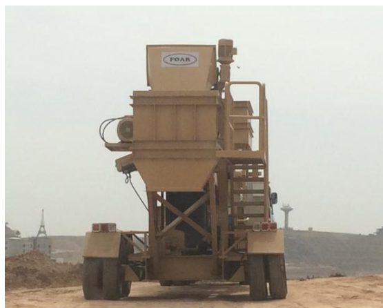
BACKSIDE: FOAR MOBILE PUGMILL PLANT
